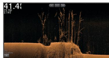
В обычных датчиках используются конусообразные лучи. Для сканирующего сонара Garmin ClearVü предусмотрено использование двух узких лучей, схожих по форме с лучом копировального аппарата. Эти лучи обеспечивают более четкое, напоминающее фотографию изображение пространства под судном.
