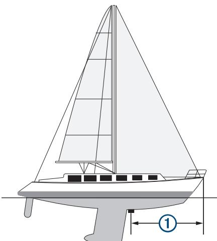
**2** В поддерживаемом режиме отображения данных сонара выберите **Меню > Настройка сонара > Установка > Смещение носа судна**.
